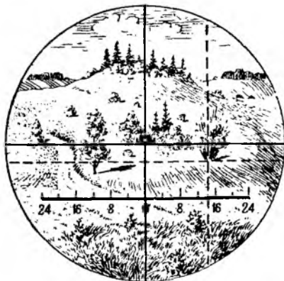
Рис. 87. Отметка по разрыву прицелом и целиком (пунктиром показано положение прицельного перекрестия после отметки).
