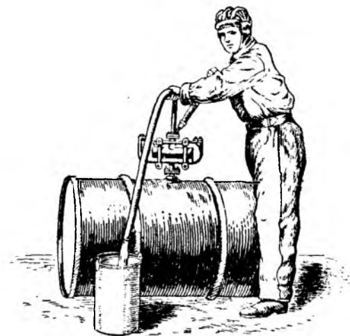
Рис. 104. Перекачка горючего из бочки при помощи ручного насоса Гарда.
