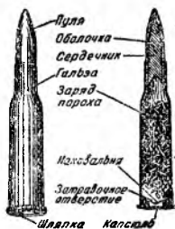
Рис. 3. Боевой патрон, общий вид и разрез
